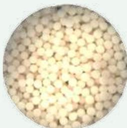
晶球為可自然分解之材料，用於包覆特定功能菌種或生物質，在地下水環境中緩慢釋放達到持續分解污染物及長時間提供生物生長營養源之功能，相當適合用於地下水流變異性較大的場址整治使用。
