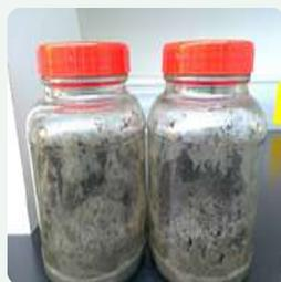
油污污染場址土壤經實驗室馴化後，篩選出具有降解功能之菌群，經發酵培養後可偵測到甲苯、萘降解基因，且具有降解苯、甲苯、以及柴油之功能，可供現場整治使用。
